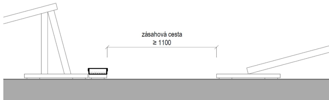
ČSN P 73 0847, Obrázek B.2: Požadované provedení zásahových cest mezi jednotlivými PV poli
